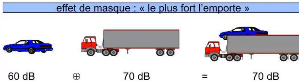
Figure 24 : Effet de masque du bruit produit par les véhicules
