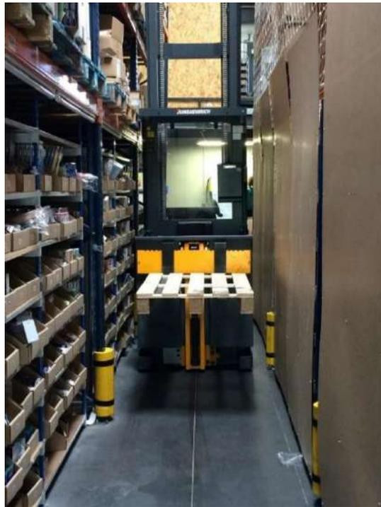
Figure 18. Préparateur de commande automatisé « Jungheinrich » (Ulliac, 2021).
